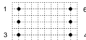
Pin Position Grid 0.100 (2.54)
